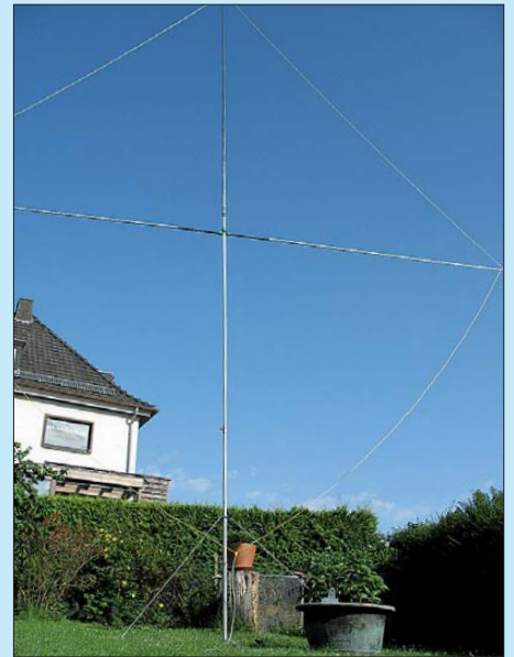
Bild 6: Quadschleife in Betrieb; man erkennt, dass die untere Spitze etwa 1 m über dem Boden endet. Fotos: DJ6SU
