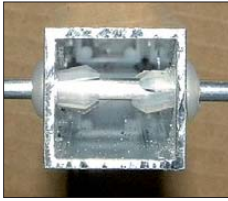
Bilder 7 und 8: Elementmontage mit den Polyamid- Nieten
