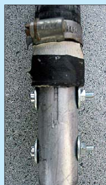
Bild 5: Übergang vom vertikalen Aluminiummast auf die Angelrute
