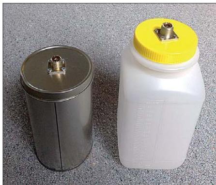
Bild 1: Lastwiderstände in Blech- und Plastikausführung; die Blechdose muss wasserdicht sein und macht den zweiten Draht (Masse) entbehrlich, nach Gebrauch aber entleeren und ausspülen (Korrosion)! Bilder: DK1IO
