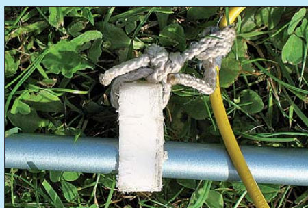
Bild 10: Befestigung des Antennendrahts am seitlichen Spreizer
