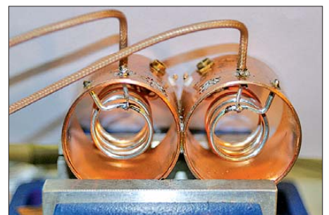
Bild 11: Draufsicht auf das Helixfilter mit der Ein- und Auskopplung Fotos: DC8RI
