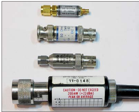
Bild 5: Beispiele für verwendbare Detektoren (von oben nach unten): HP-Detektor 33330B (10 MHz bis 18 GHz); GR-50 Negativ (0,5 MHz bis 5 GHz); Narda-Detektor (10 MHz bis 18 GHz); PM-Detektor mit Präzisions-N-Buchse (1 MHz bis 18 GHz)
