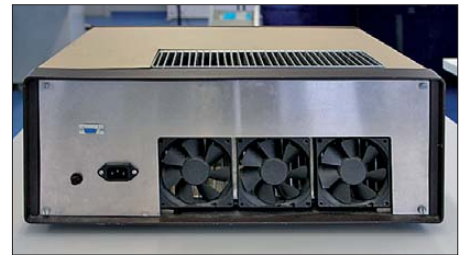
Bild 16: Unverzichtbar für die korrekte Funktion der elektronischen Last ist eine ausreichend schnelle Abführung der entstehenden Verlustwärme. Die drei Lüfter auf der Rückseite erzeugen den nötigen Luftstrom, der zwischen die Kühlkörperrippen gedrückt wird und an der Oberseite wieder austritt. Foto, Screenshots: DF6WU
