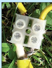
Bild 9: Anschluss des Koaxialkabels an der unteren Ecke der Drahtschleife; das Koaxialkabel besteht hier aus 75-Ω-Koaxialkabel.
